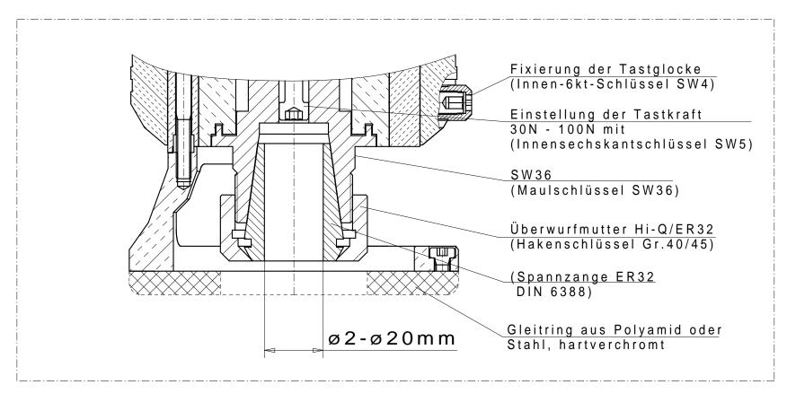
Alternative Spannzangenaufnahme Hi-Q/ER40
